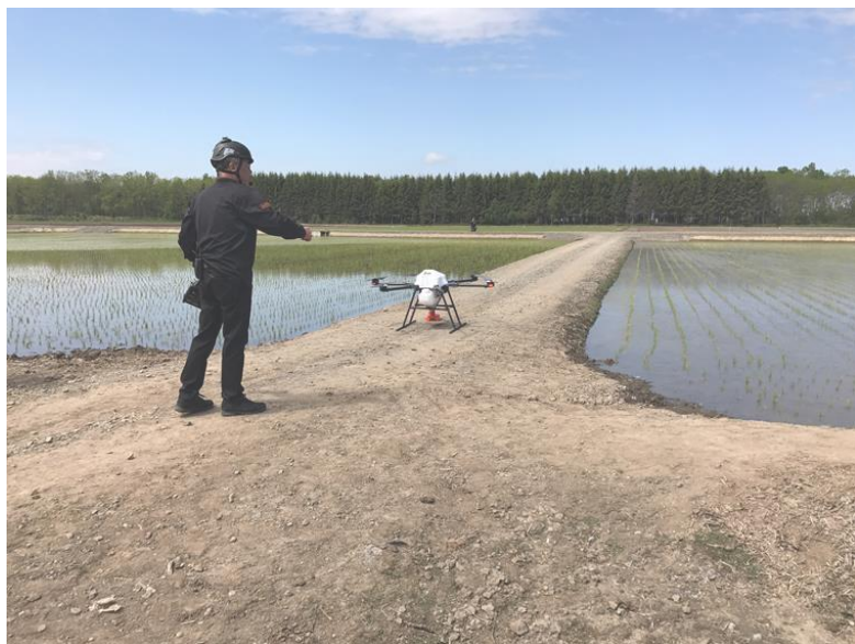
ドローンによる豆つぶ剤散布試験
