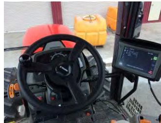
設定した作業経路を自動操舵するICT農機
