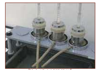
飽和透水試験状況
