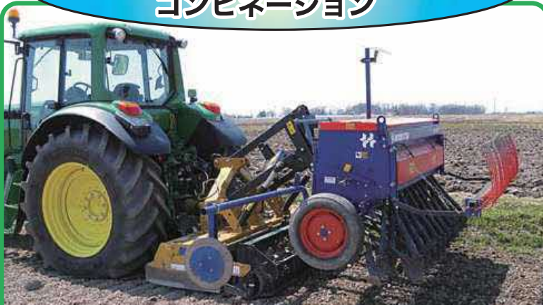
アルペゴパワーハロー、シーダーヒッチ 2.5m幅ノードストーン(シュータイプ)
