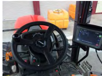
設定した作業経路を自動操舵するICT農機
