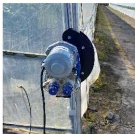
写真3 自動換気装置
