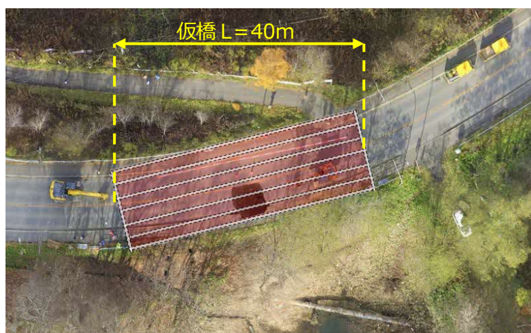
図 4-1 応急対策(仮橋案)イメージ
