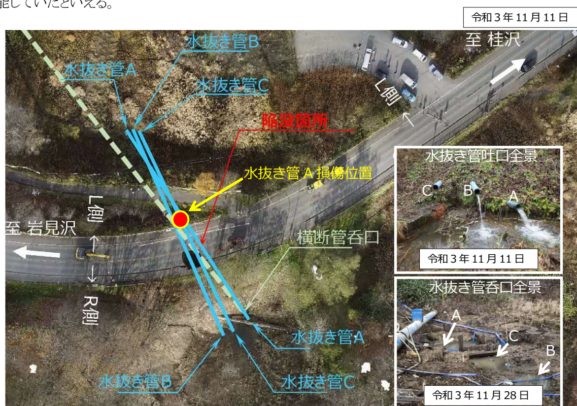
図 2-14 水抜き管損傷箇所位置図
