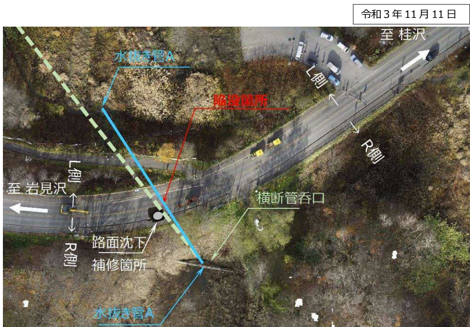
図1-13 路面沈下箇所と沈没箇所の位置関係
