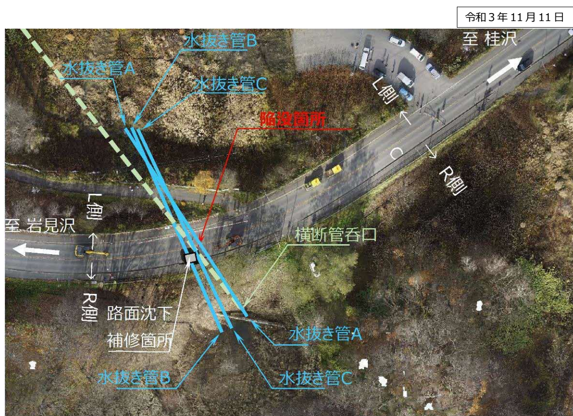
図1-19 路面沈下箇所と陥没箇所の位置関係
