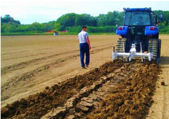
写真18 施工は「徒歩でついていける くらいの早さ(4km/時)」がベスト
