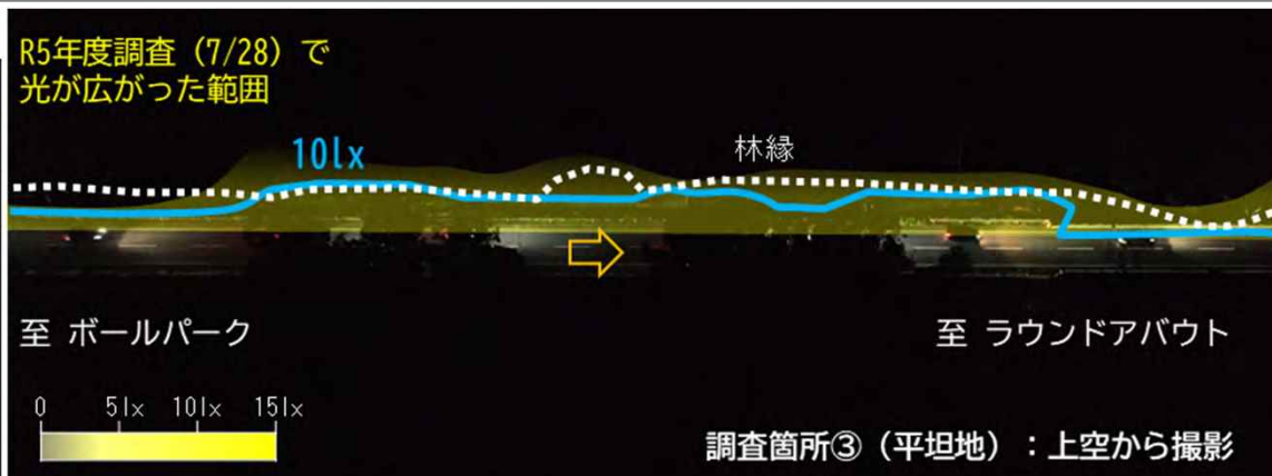
図20.ヘッドライトの照度調査結果（R5年7月28日 ナイター終了後）
