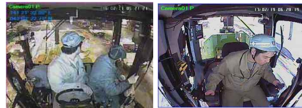
二人乗り 図-1 除雪グレーダの運転室内状況 一人乗り（ワンマン）
