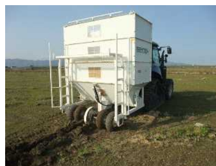
図3 有材心土破碎は有効な排水対策
