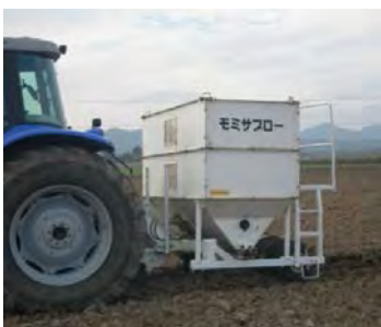
モミサブロー（施工深50cm 疎水材：粃殻）
