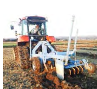
カットソイラ（施工深40cm 疎水材：稻株+表土）
