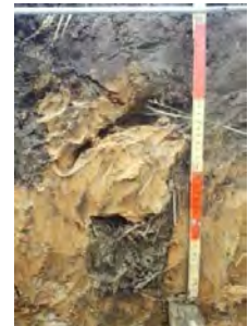
カットソイラ（施工深40cm 疎水材：稻株+表土）
