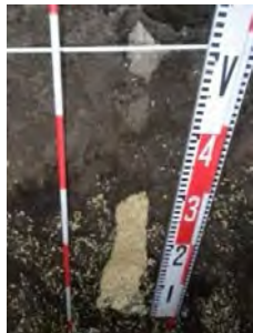
モミサブロー（施工深50cm 疎水材：粃殻）
