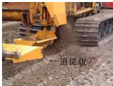
写真1 重粘土畑に対応したトレンチャ施工機
