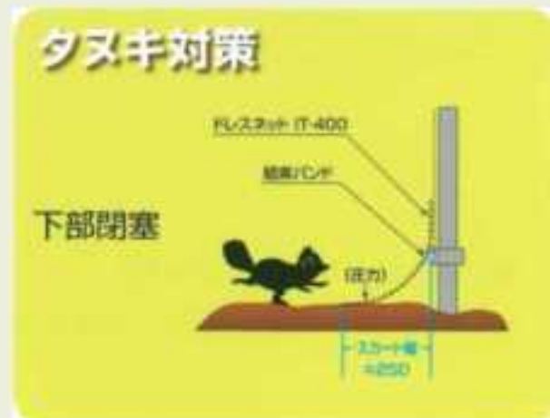
正面図 (IT-400) 結束バンド:2本/mスカート幅250mm程度
